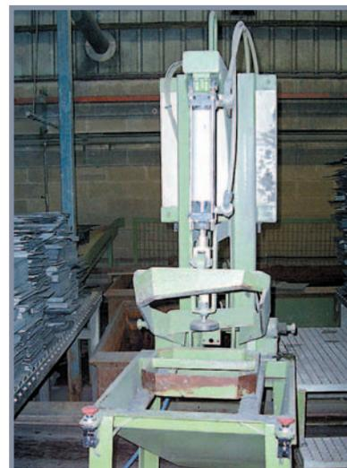
El proceso de cada pieza se inicia en el momento que la operadora alimenta la máquina a través de la cinta de entrada, quien la traslada a la zona de corte por disco, haciéndolo longitudinalmente.
